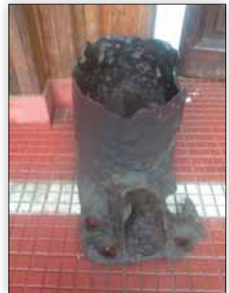
Tintero de la fragata "Independencia" que afirmaba el mástil a la estructura del buque.
